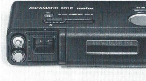
Batterieraumdeckel (1) an der Griffmulde nach links abziehen. Batterien entsprechend den Pol-Markierungen einsetzen. Batterieraumdeckel wieder aufsetzen und bis zum Einrasten zurückziehen.
