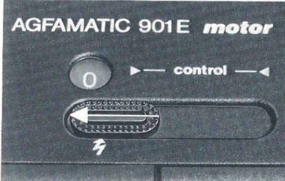
Kassettenraumdeckel öffnen (s. Pos. 2), pocket-Kassette entnehmen und Kamera wieder schließen. Zentrale Schalter (3) nach links schieben, bis im Fenster (16) die 0-Markierung erscheint. Die Sensor-Auslösung ist jetzt gesperrt.
