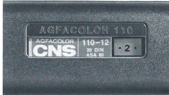
Unmittelbar nach der Auslösung wird der Film automatisch weitertransportiert und die nächste Bildnummer erscheint im Filmfenster. Die Kamera ist also sofort wieder aufnahmefertig.
