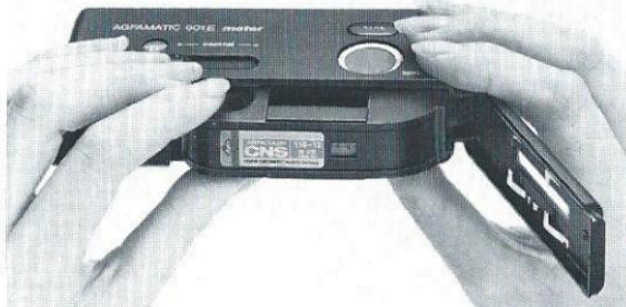
Pocket-Kassette wie abgebildet einlegen. Das Einstellen der Filmempfindlichkeit erfolgt dabei automatisch. Kassettenraumdeckel schließen, andrücken und Batterieraumdeckel bis zum Anschlag nach rechts schieben.
