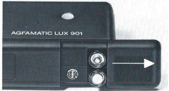
Wenn die Blitzkontrolllampe erst nach längeren Abständen (ca. 1 min) aufleuchtet, müssen die Batterien im Blitzgerät (s. Abb. oben und Pos. 10) und evtl. auch die in der Kamera (s. Pos. 1) gewechselt werden.
