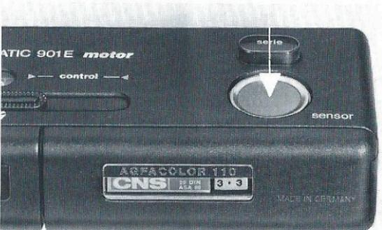
Die Kamera belichtet und transportiert den Film jetzt automatisch, solange der rote Sensor (6) gedrückt wird (ca. jede Sekunde eine Aufnahme).
