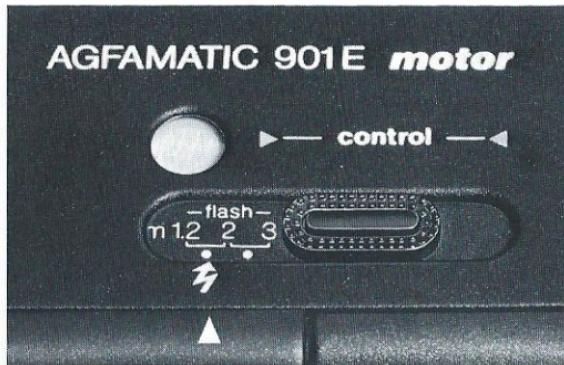
Entsprechenden Blitzbereich mit dem Zentralschalter (3) auf das Blitzzeichen der Kamera (17) stellen. Die Agfamatic 901 E ist auf zwei Blitzbereiche einstellbar 1,2—2 m und 2—3 m (s. Tabelle S. 13). Mit dem roten Sensor (6) auslösen.
