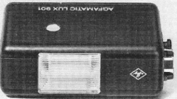
**Das Elektronenblitzgerät AGFAMATIC LUX 901** wurde speziell für die Agfa motor pocket-Kameras entwickelt. Der Blitz wird mit zwei Batterien 1,5 V (Größe AAA) bestückt. Die Kamera-Batterien werden zur Stromversorgung mitbenutzt.
