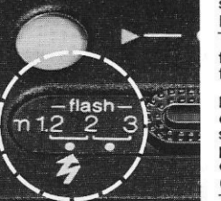
**Blitzbereitschaft:** Nach ca. 12 sec. leuchtet die Kontrolllampe am Blitzgerät auf. Blitzentfernung an der Kamera (Agfamatic 901 S / 901 E) einstellen und mit dem roten Sensor auslösen.
