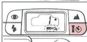
**3-Mode déclenchement différé de 3 secondes:** le déclenchement s'effectue 3 secondes après que le déclencheur de la
