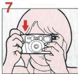
7 Pressez le déclencheur. Dans l'obscurité, le flash se déclenche automatiquement (voir page 19).
