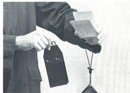
4. Ouvrez immédiatement le réchauffeur et y placez l'ensemble positif/négatif, la languette restant à l'extérieur comme ci-contre. **Ceci doit être fait dans les 10 secondes suivant l'extraction.**
