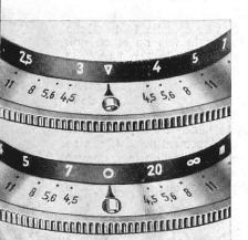
Les vues non préparées (jeux d'enfants) donnent de très jolies photos. Dans des cas de ce genre, on renonce à une mise au point rigoureuse. Pour des sujets situés entre 2,50 et 5 mètres, on met au point sur la marque ∇ pour vues rappochées et pour des sujets placés entre 5 et 10 m sur la marque O Ceci suppose toutefois que l'éclairage est suffisant, ce qui permet de diaphragmer à f/11 et d'opérer ainsi à coup sûr.
