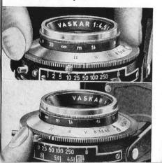
A l'aide d'un posemètre ou d'un tableau de temps de pose, vous déterminez le temps de pose en tenant compte du diaphragme. Pour le réglage, tournez la baque jusqu'à coïncidence de la marque avec le temps de pose choisi. Les nombres expriment des fractions de seconde sauf 1 = 1 sec. Pour l'indication B (pose longue) voyez à la page 15. Avant chaque prise de vue, armez l'obturateur avec le levier 8 Tirez celuici jusqu'à enclenchement complet à fond vers le haut (sur la figure, vers la droite).
