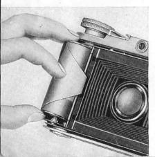
Après avoir pris la dernière vue tournez le bouton 14, jusqu'au passage de l'extrémité du papier protecteur dans la fenêtre de contrôle. Ouvrez la paroi arrière, tirez le bouton d'enroulement jusqu'à la butée et immobilisez-le dans cette position, en lui faisant exécuter un quart de tour.
