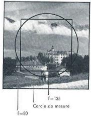
Le petit cercle de mesure constitue un avantage particulier du LUNASIX. Il vous permet d'effectuer une mesure très précise et bien dirigée, car il vous permet d'explorer les différentes parties du sujet beaucoup plus facilement qu'avec un posemètre usuel.
