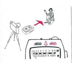
Mesure de lumière réfléchie: Pousser le volet (1) complètement vers la droite, ce qui amène au centre la fenêtre ronde. Dès le verrouillage du volet, le LUNASIX est prêt à effectuer une mesure. On le dirige vers l'objet comme l'indique la flèche.
