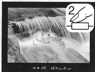
Tout en maintenant la touche de mémorisation d'expo. enfoncée, placer le sujet dans la zone de cadrage et appuyer à mi-course sur le déclencheur pour faire la mise au point (2). Appuyer à fond sur le déclencheur pour prendre la photo.
