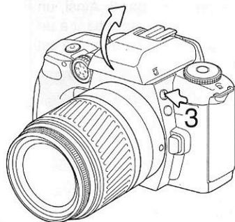
Pour utiliser le fill-flash, appuyer sur la touche mode flash (3) pour ériger le flash. L'exposition du flash est contrôlée automatiquement par l'appareil.
