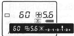
Une fois l'exposition réglée, l'indicateur de correction d'exposition précise si l'exposition en cours est en surexposition (+) ou en sous-exposition (-) par rapport à celle mesurée. L'échelle d'exposition du viseur affiche le degré de correction.
