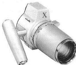
L'Electro-zoom X était un reflex mécanique avec contrôle électronique de la priorité à l'ouverture et zoom 30 - 120 mm f/3,5 intégré. Il permettait de réaliser 20 vues 12 x 17 mm sur un rouleau de film 16 mm. Le déclencheur et le compartiment piles étaient situés dans la poignée. Seuls quelques prototypes furent fabriqués. Il s'agit donc de l'un des appareils Minolta les plus rares.
