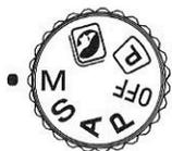
Le mode Manuel permet au photographe de régler la vitesse et l'ouverture. Pour davantage d'informations sur les réglages de l'ouverture et de la vitesse, voir page 30. Il est également possible de faire des poses longues (bulb), se référer à la page 40.
